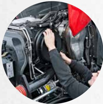
Continue reiniging via een piclon-filter zorgt ervoor dat het filter alleen hoeft te worden onderhouden wanneer het betreffende waarschuwingsslampje aan gaat.
