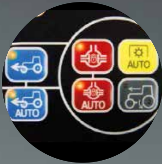
Automatisch beheer van de vierwielaandrijving en het differentieelslot
