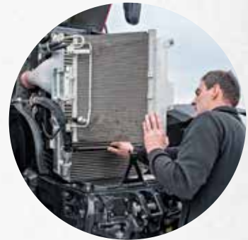
Snelle en eenvoudige reiniging van de koeler en de airconditioning.
